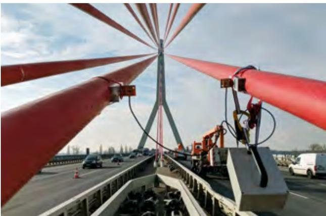
Schwingungsmessung zur Ermittlung der Vorspannkraft.
